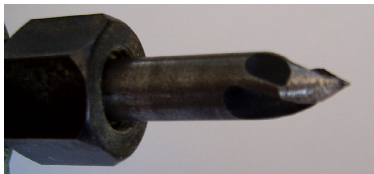
103. ábra A fúróhegyből készített „karctű”
