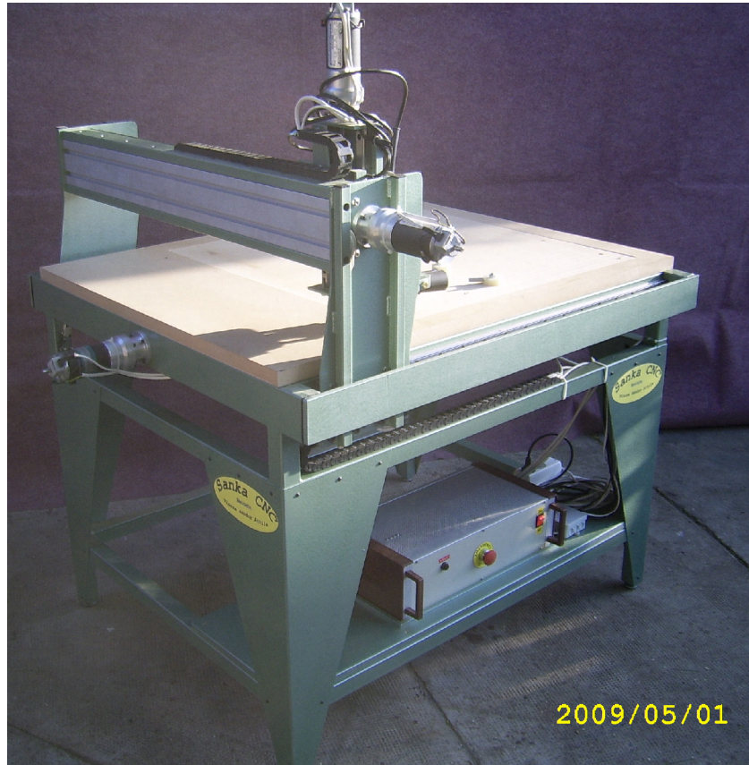
91.ábra A CNC marógépem a vezérlővel és szervomotorokkal
