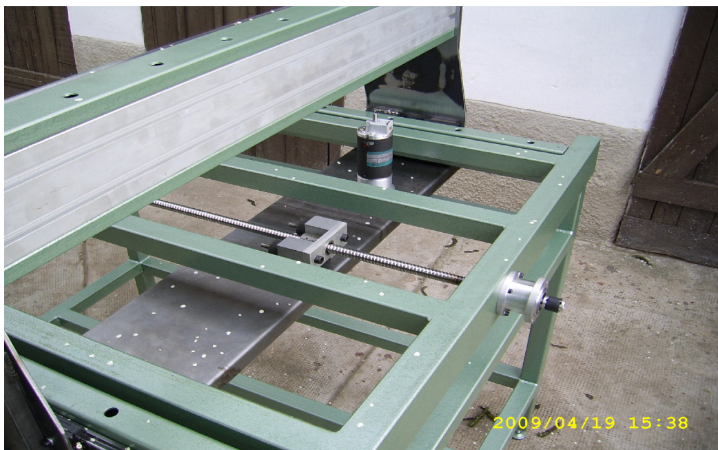
80.ábra Az x tengely próbaszerelése
