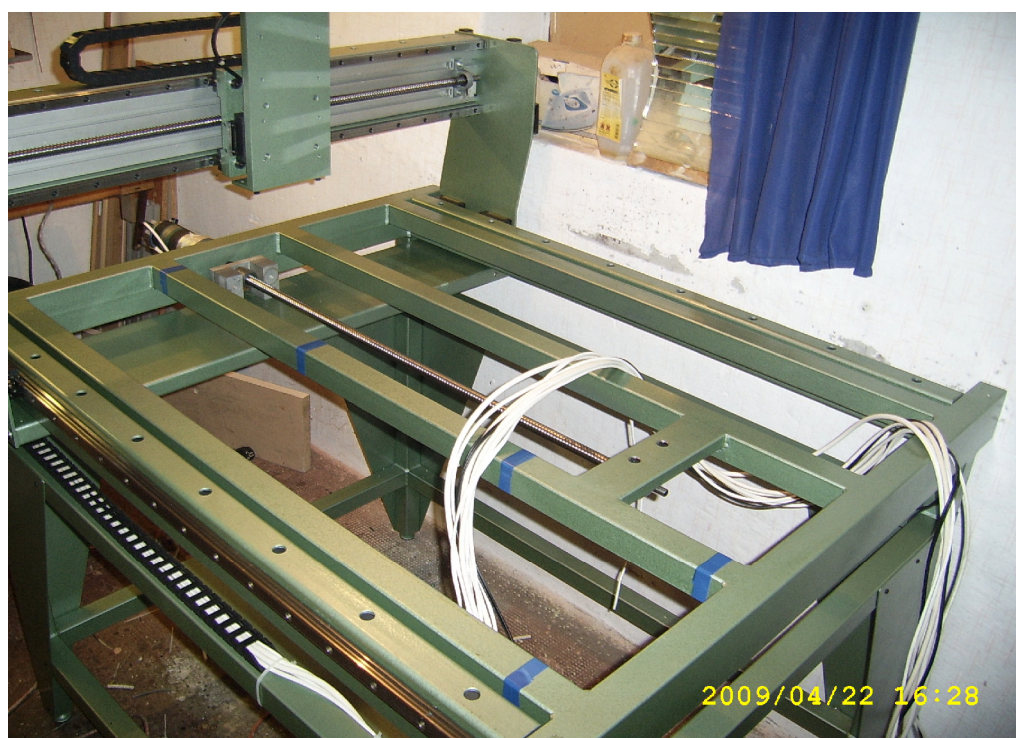
88.ábra Kész van a vezetékezés, már csak a csatlakozások bekötése hiányzik
