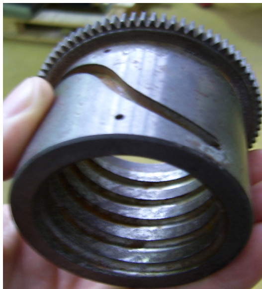
37. ábra Teljes visszavezetésű golyós anya (Csepeli Szerszámgépgyár)
