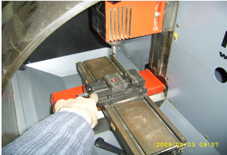
16. ábra A főorsó motor és a munkadarab megfogó szerkezet
