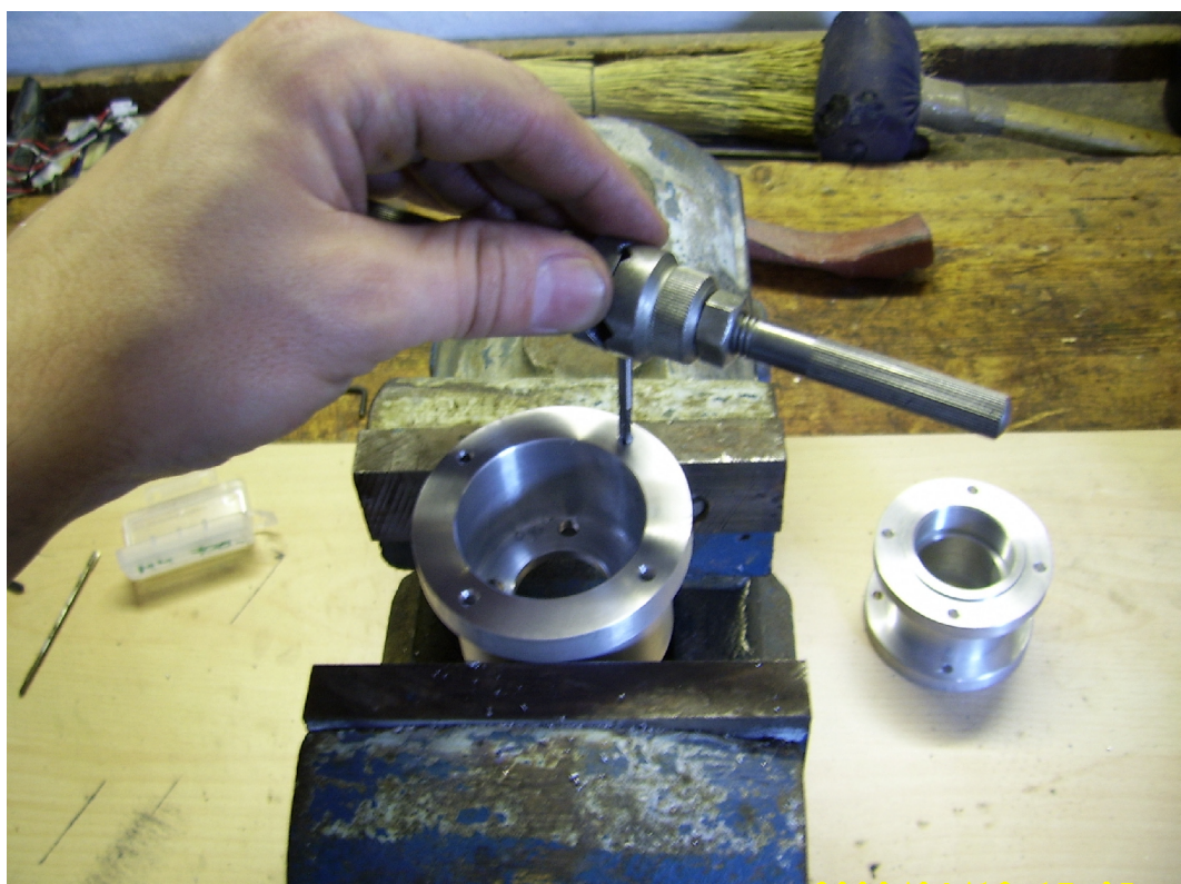
78.ábra A golyósorsó egység csapágyháza és motortartója
