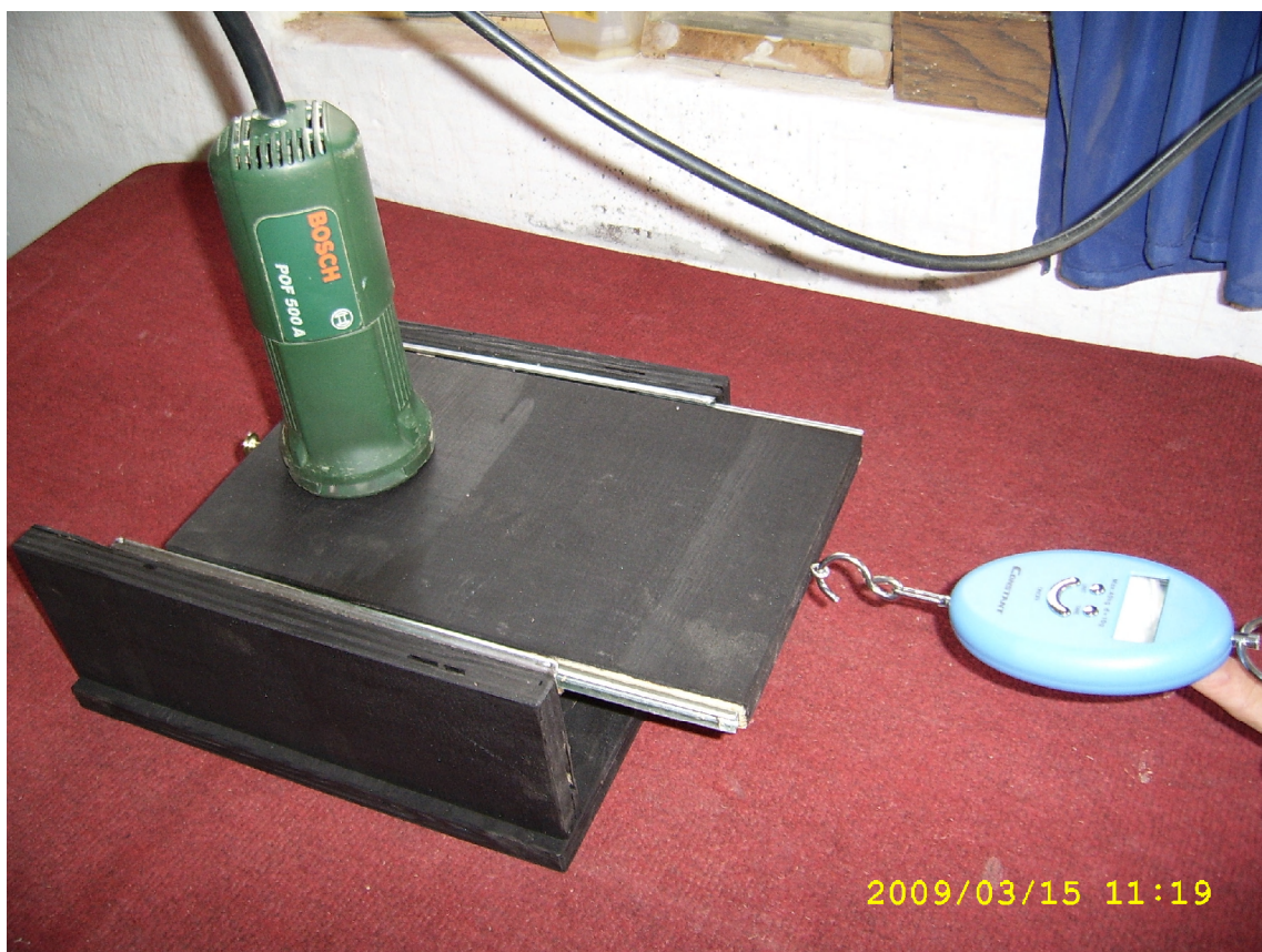
49. ábra Az előtolási ellenállás mérésére szolgáló szerkezet rajza
