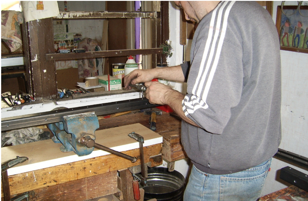
72. ábra Az x tengely lineáris vezetőtartóinak menetfúrása
