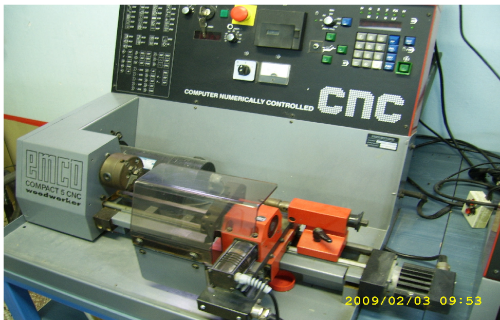
20. ábra EMCO COMPACT 5 CNC kiseszterga (Sághy Mihály Szakközépiskola és kollégium)
