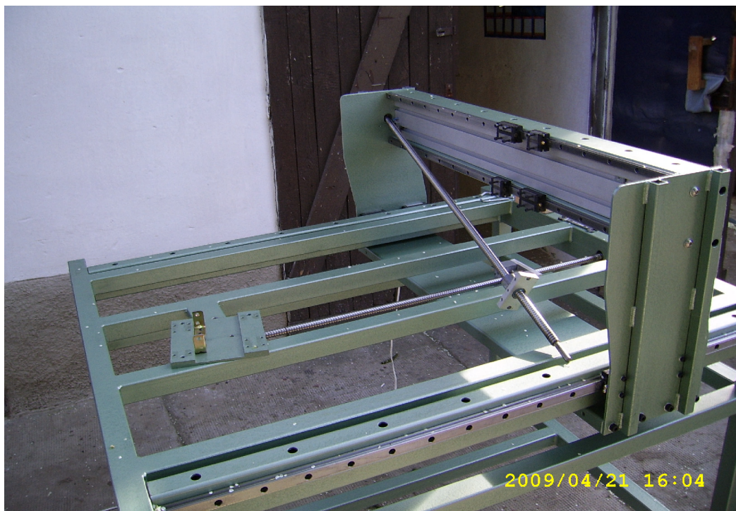
83.ábra Az y tengely golyósorsójának szerelése
