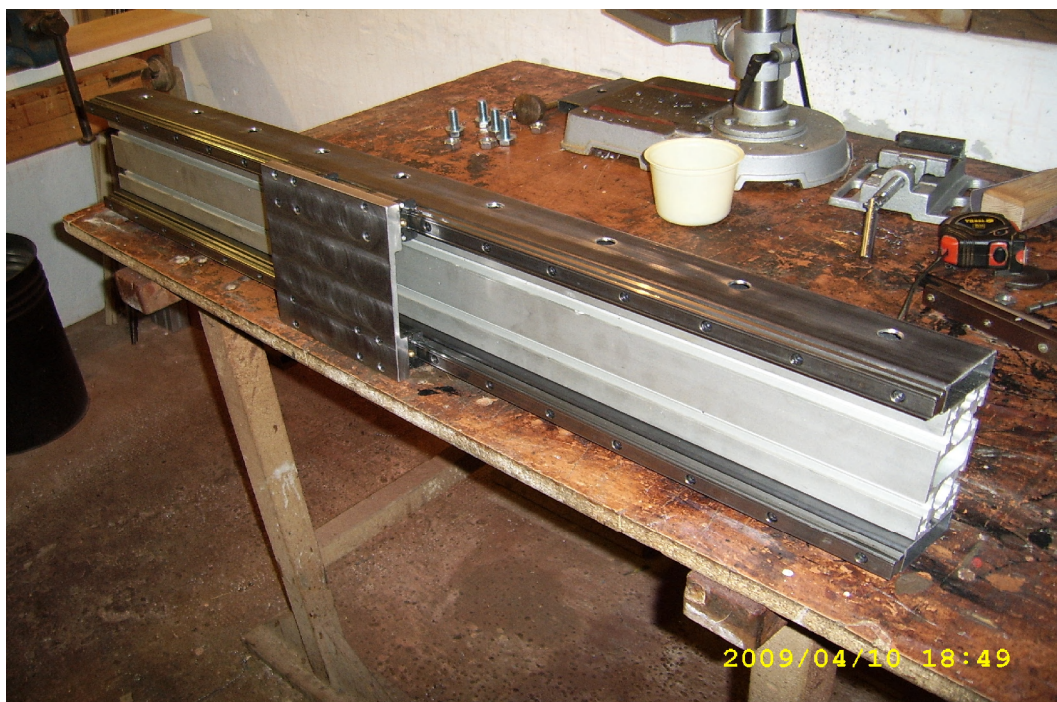
75. ábra Az y tengely próbaállítása
