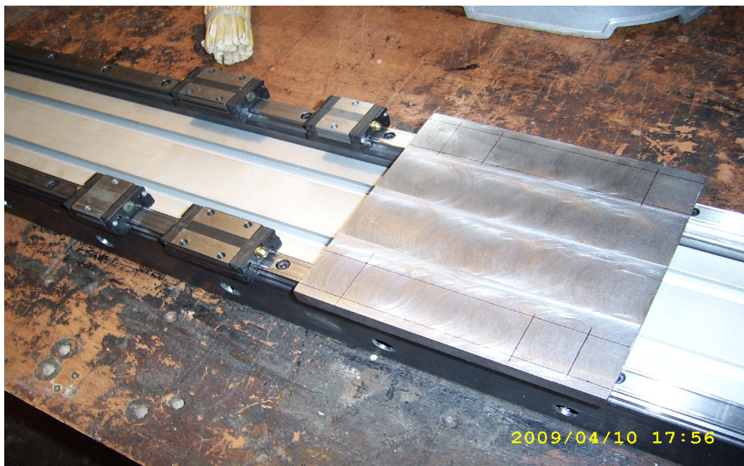
74.ábra Az y tengely lineáris vezetőkeinek felerősítése a gerendára
