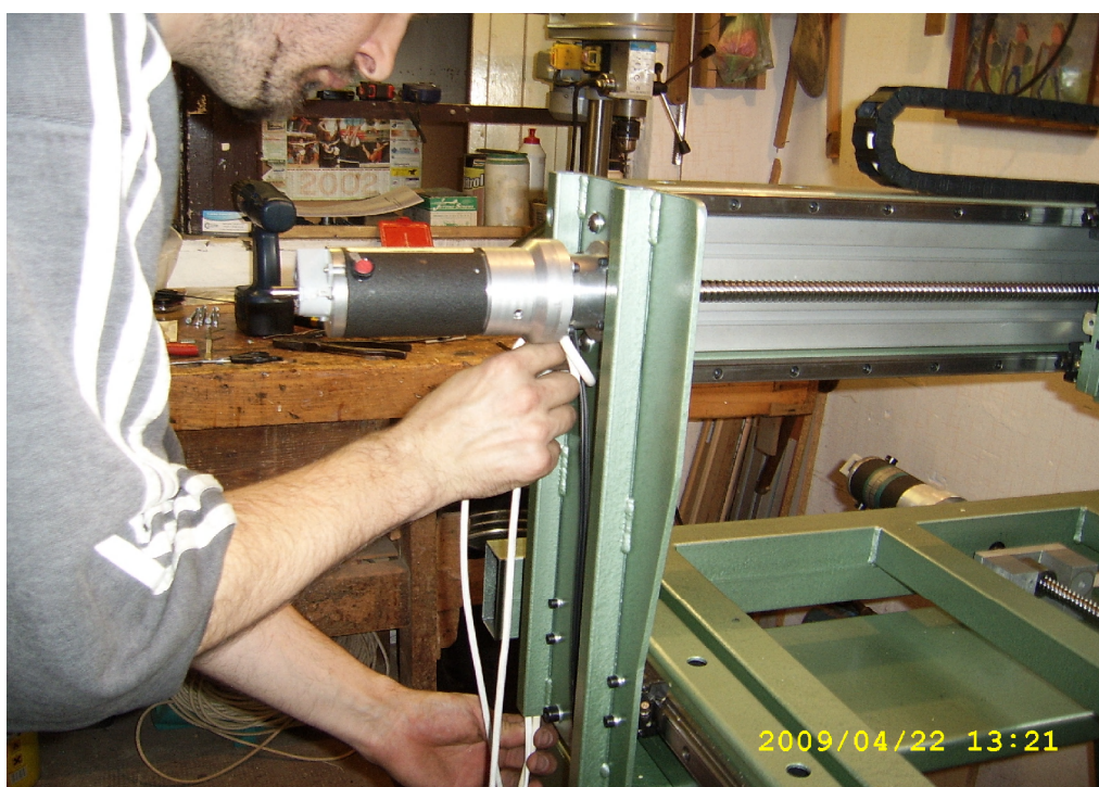
87.ábra Az y tengely elektromos vezetékeinek „bújtatása”
