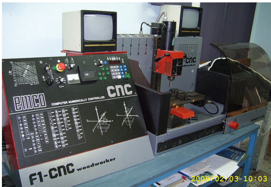
15.ábra EMCO F1 CNC marógép ( Sággy Mihály Szakközépiskola és Kollégium)
