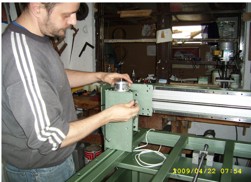
86.ábra A z tengely felszerelése
