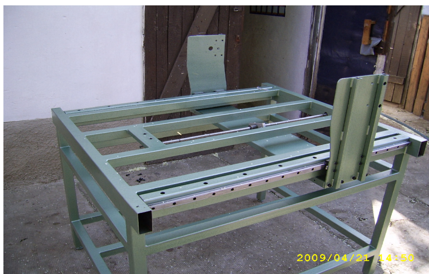
82. ábra A felső gerenda egység végleges szerelése
