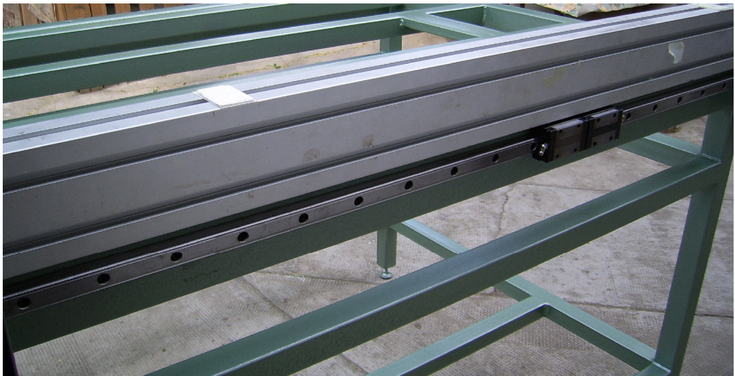
73. ábra Az x tengely felcsavarozása és beállítása
