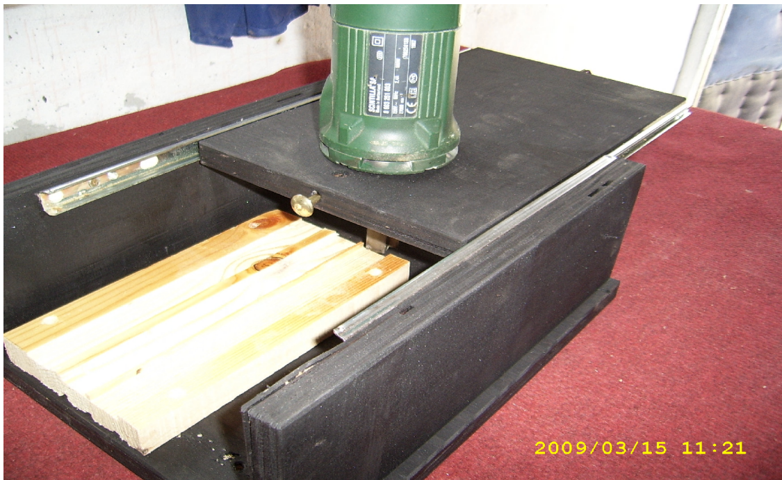
52. ábra Előtolási ellenállás mérése erdei fenyő próbadarabbal
