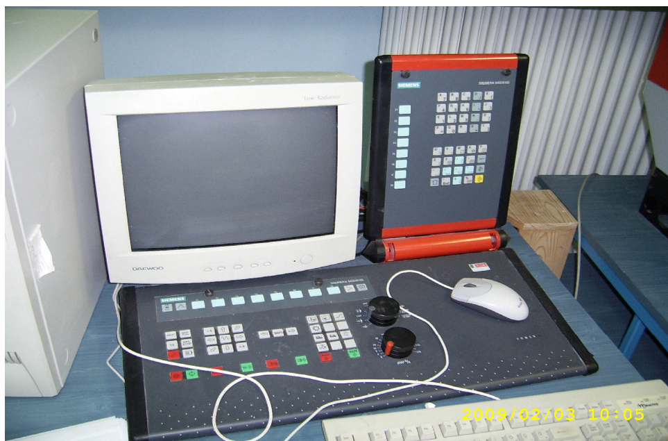
25. ábra Az F1 CNC marógép különálló vezérlőpultja
